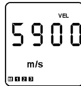
Отображение последнего установленного значения скорости звука и ячеек памяти, которые использовались в предыдущем сеансе измерений
