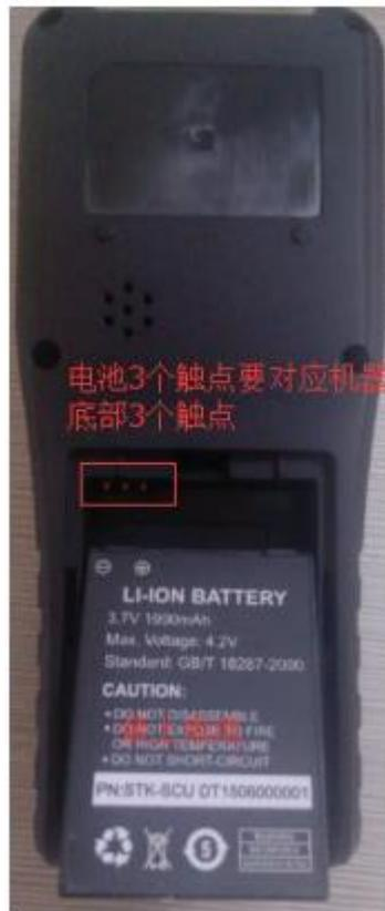
1.4.3. Установка крышки аккумулятора. Приложите небольшое усилие для того, чтобы поместить крышку аккумулятора на место, затем подвиньте ее вверх, как показано на следующем фото:
