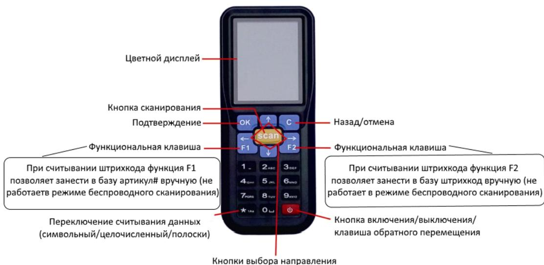
Кроме выбора направления, при чтении штрих-кода клавиша со стрелкой вверх также используется для переключения между режимами сохранения данных в режиме реального времени (не работает в режиме беспроводного сканирования), а клавиша со стрелкой вниз - для переключения между автоматическим и ручным вводом количества позиций
