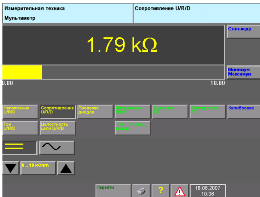
Рис. 5-6 Окно «Мультиметр», измерение сопротивления
