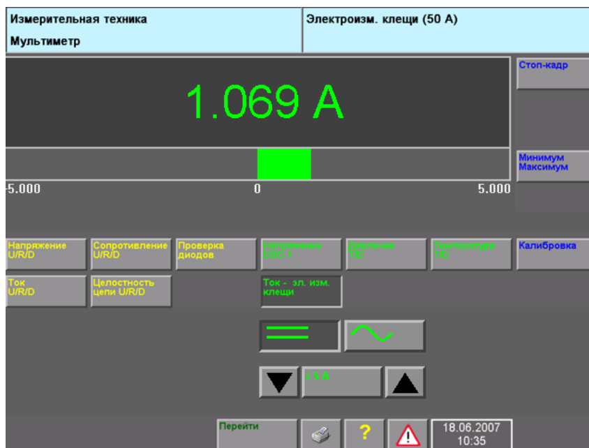
Рис. 5-5 Окно «Мультиметр», измерение силы тока с помощью токоизмерительных клещей на 50 А
