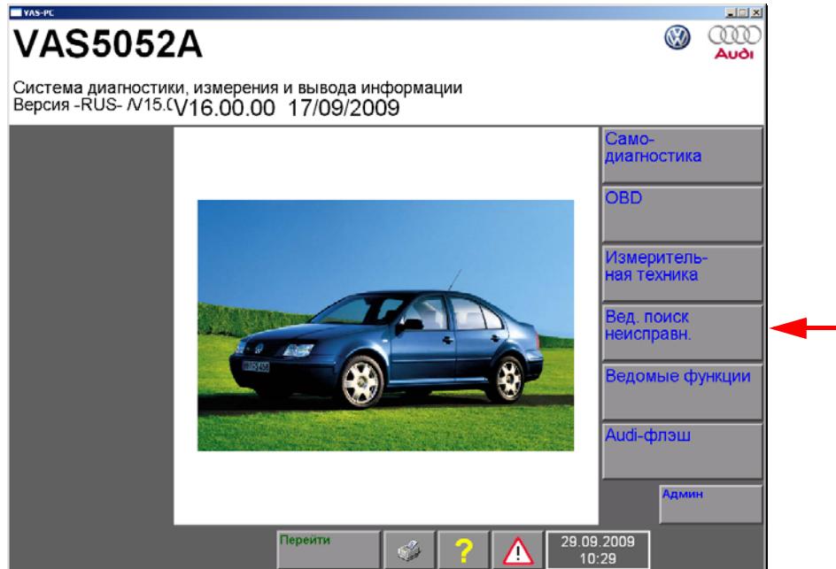
Рис. 6-2 Запуск ведомого поиска неисправностей
