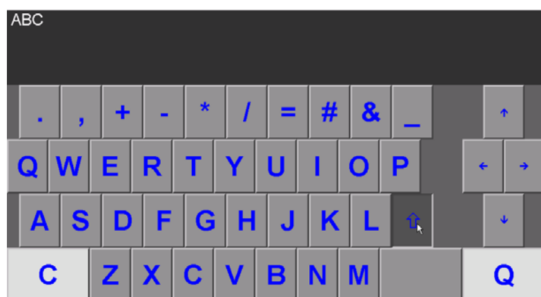
Рис. 3-7 Буквенно-цифровая клавиатура (прописные буквы) с полем отображения, клавиша «Верхний регистр» нажата и отображается темно-серым цветом.
