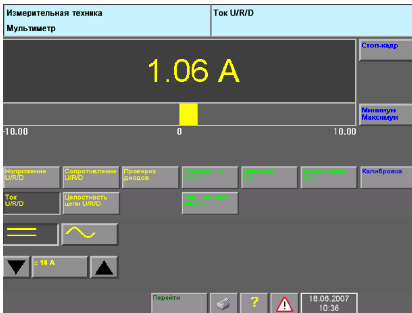
Рис. 5-4 Окно «Мультиметр», измерение силы тока
