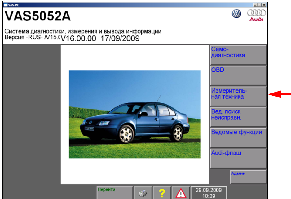
Рис. 5-1 Стартовое окно, вызов функции «Измерительная техника»
