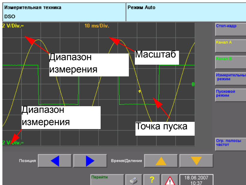
Рис. 5-12 Окно «DSO», базовая установка
